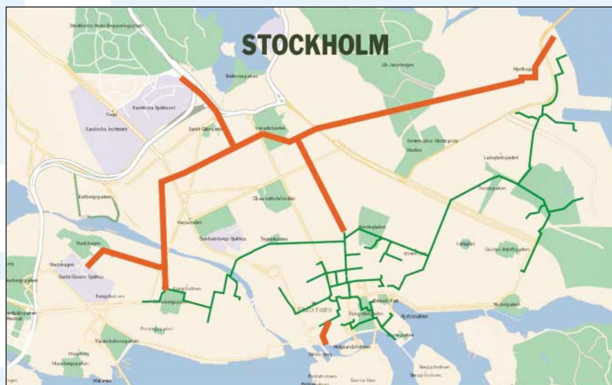
Med rött på kartan markeras det nya transiteringssystemet som utgår från Värtaverket och sträcker sig vidare ut mot Kungsholmen och Hornsberg. Total längd är ca 9 km huvudledning och ca 2,8 km fördelnings- och servisledning. Det befintliga nätet är markerat med grönt.
